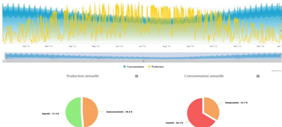
Mise en parallèle d'une courbe de production et de consommation électrique, sur un an.
