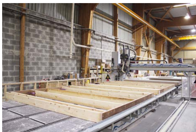
Figure 5 - Exemple de fabrication de murs à ossature bois (MOB) en atelier chez Savare. © Eiffage
