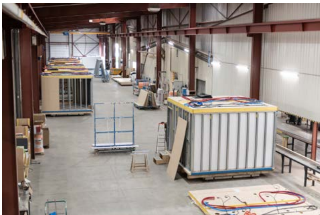
Figure 6 - Un atelier de fabrication de Modules sanitaires 3D (GA smart building). © Grégory Tachet - Studio Montazami et Tezuka Architects
