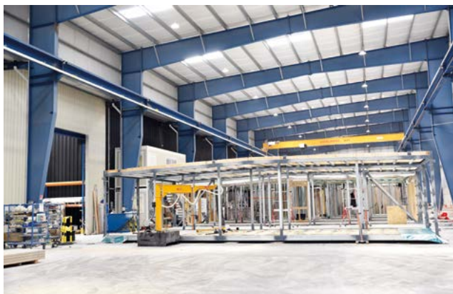
Figure 2 - Fabrication en atelier de modules 3D chez Avelis. © Avelis - Cédric Colin
